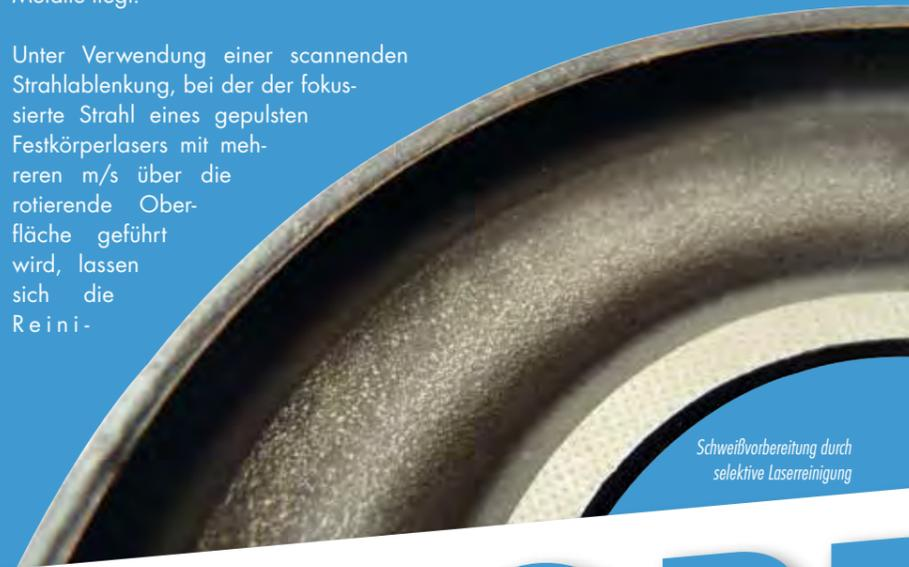
Schweißvorbereitung durch selektive Laserreinigung
