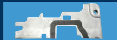
Haftverbesserung durch Laservorbereitung
