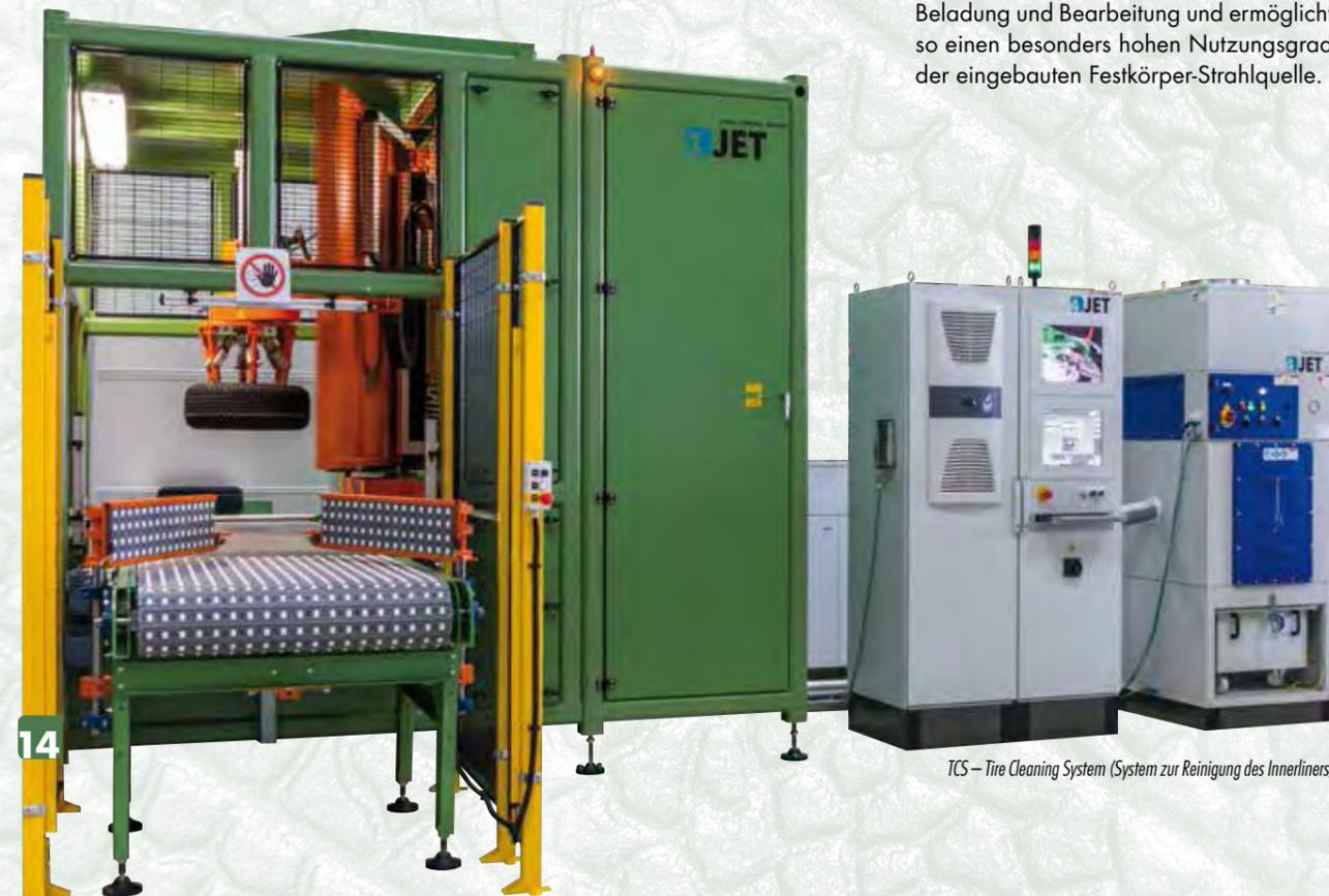
TCS – Tire Cleaning System (System zur Reinigung des Innerliners)
